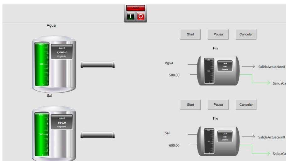
*Ilustración 4.11 .- Visualización con dos tanques y dos válvulas*
