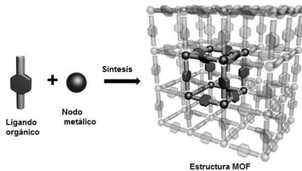
Figura 1. Esquema básico de la estructura de un MOFs.<sup>2</sup>
