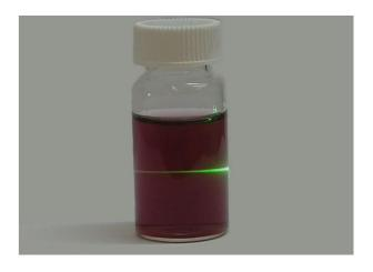
Figura 4. Observación del efecto Tyndall en las AgNPs sintetizadas.
