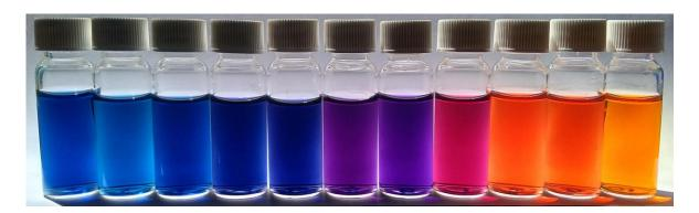
Figura 5. Viales con las AgNPs sintetizadas, ordenados de menor a mayor contenido en KBr.
