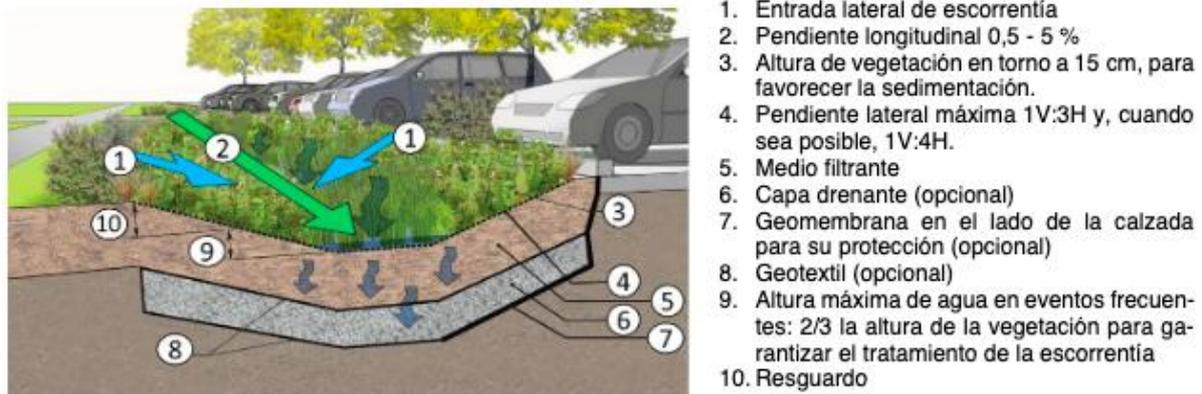
Figura 2.11 Fuente: *Adaptado de Clean Water Services (2016)*. Fuente: : (Del et al., 2000)
