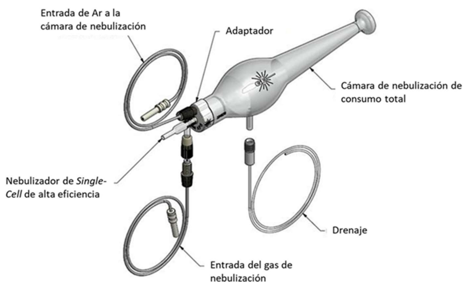
Figura 52.- Representación esquemática del sistema de introducción de muestra de alta eficiencia High Sensitivity Single-Cell Sample Introduction System de Glass Expansion.
