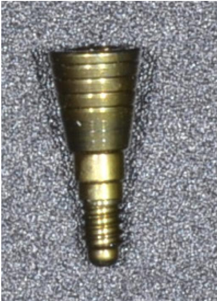
FIGURA 12. Imagen de uno de los pilares de cicatrización fabricados ad hoc para este estudio. Obsérvense las marcas realizadas con láser cada 0,5mm para poder cuantificar de manera objetiva el crecimiento óseo en sentido vertical.
