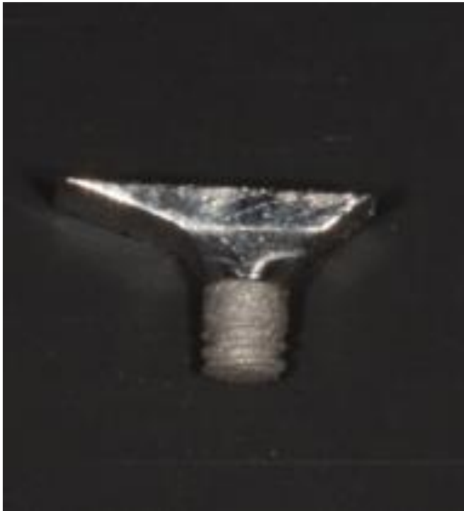
FIGURA 24. Imagen del implante fabricado en Ti-6Al-4V para el estudio, con la pletina acoplada a su conexión interna.
