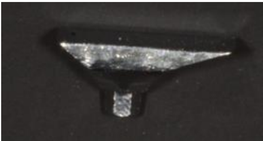
Figura 25. Imagen de la pletina de acero que cumpliría las funciones de restauración protésica.
