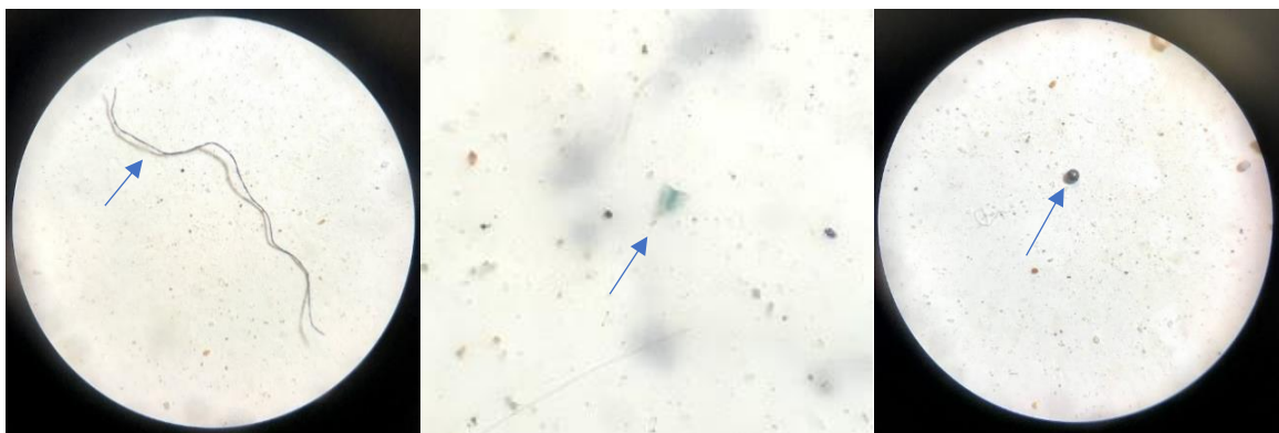
Figura 3: Imágenes de los distintos tipos de microplásticos encontrados en la presente tesis, clasificados según su forma. De izquierda a derecha: Fibra, pieza de plástico y pellet. Fuente: Paula Masiá.
