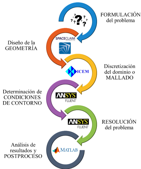
Figura 25. Etapas para resolver un problema con CFD y software utilizado en cada etapa para la resolución de los modelos numéricos presentados.
