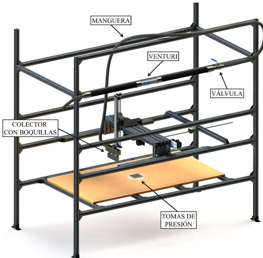
Figura 43. Esquema del banco experimental e instrumentación.
