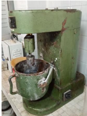
Imagen 1 – Amasadora planetaria y detalle del dispositivo de accionamiento
