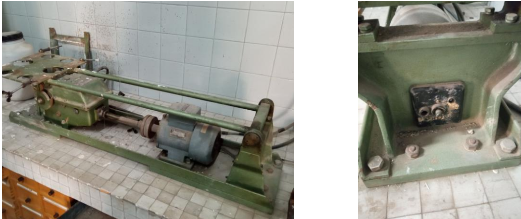
Imagen 2 – Compactadora y detalle del órgano de accionamiento.
