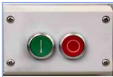
Imagen 5 – Órganos de accionamiento encastrados con identificación adicional.
