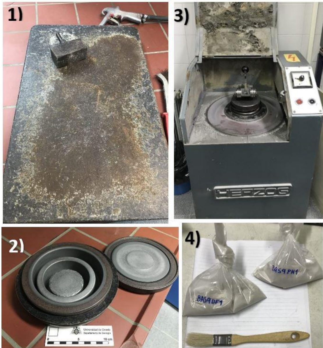
Figura 3.5- Equipo utilizado para el proceso de molienda. 1) Plancha y mazo para fragmentar la roca. 2) Recipiente de molienda compuesto por discos vibratorios entre los que se depositaron los fragmentos. 3) Máquina de molienda donde se situó el recipiente (2). 4) Resultado del proceso de molienda.
