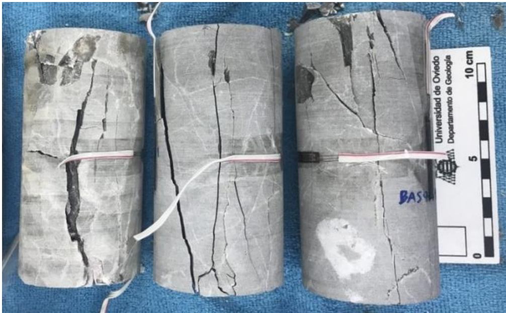
Figura 4.10- Probetas tras la rotura llevada a cabo en el ensayo de compresión uniaxial.
