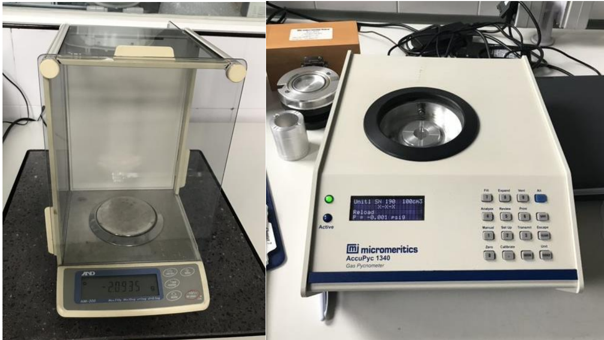
Figura 3.8- Equipo utilizado para el ensayo de determinación de la densidad real y total a partir del picnómetro de helio. A la izquierda, se puede ver la balanza y a la derecha el picnómetro de gas.
