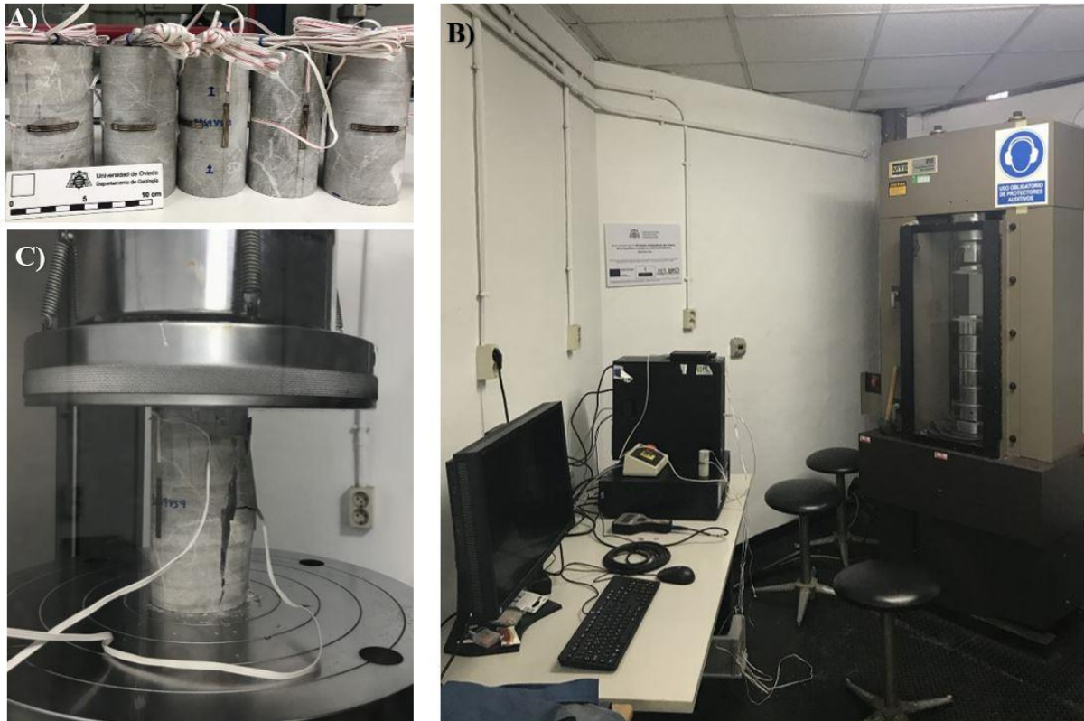
Figura 3.9- A) Probetas preparadas para el ensayo de rotura bajo compresión uniaxial tras haber colocado las bandas extensométrica. B) Prensa y equipo informático utilizados. C) Rotura de la probeta BAS9VS9.
