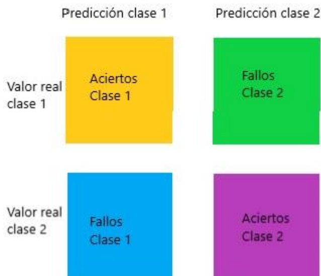
Figura 2.12.- Valores en la predicción de dos clases de objetos en una imagen.
