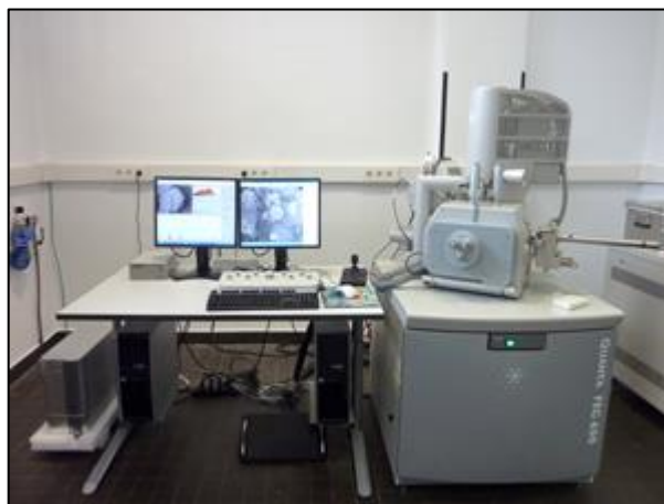
Fig. 41. Microscopio electrónico de barrido Quanta FEG 650.
