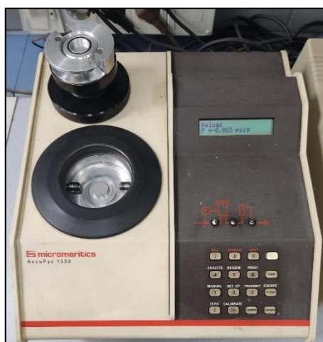
Fig. 40. Picnómetro de helio micromeritic AccuPyc 1330
