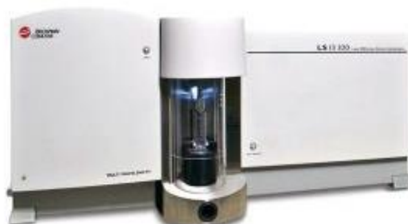
Fig. 39. Equipo de difracción láser LS13320 de Beckman Coulter.
