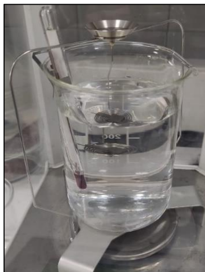
Fig. 43. Montaje para el sistema de medida de la densidad por el método de Arquímedes.
