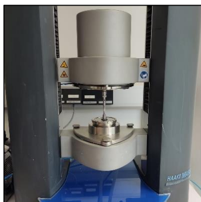
Fig. 42. Reómetro HAAKE MARS 40
