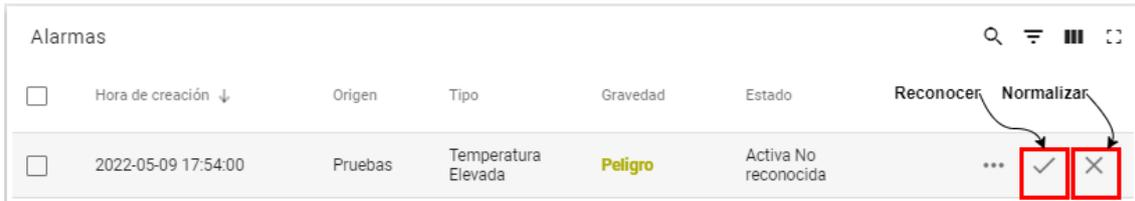
Ilustración 159: Panel de alarmas de temperatura
