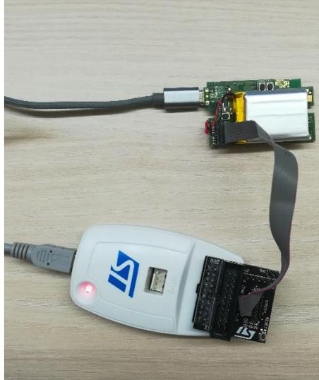
Ilustración 44: Conexión placa y debugger
