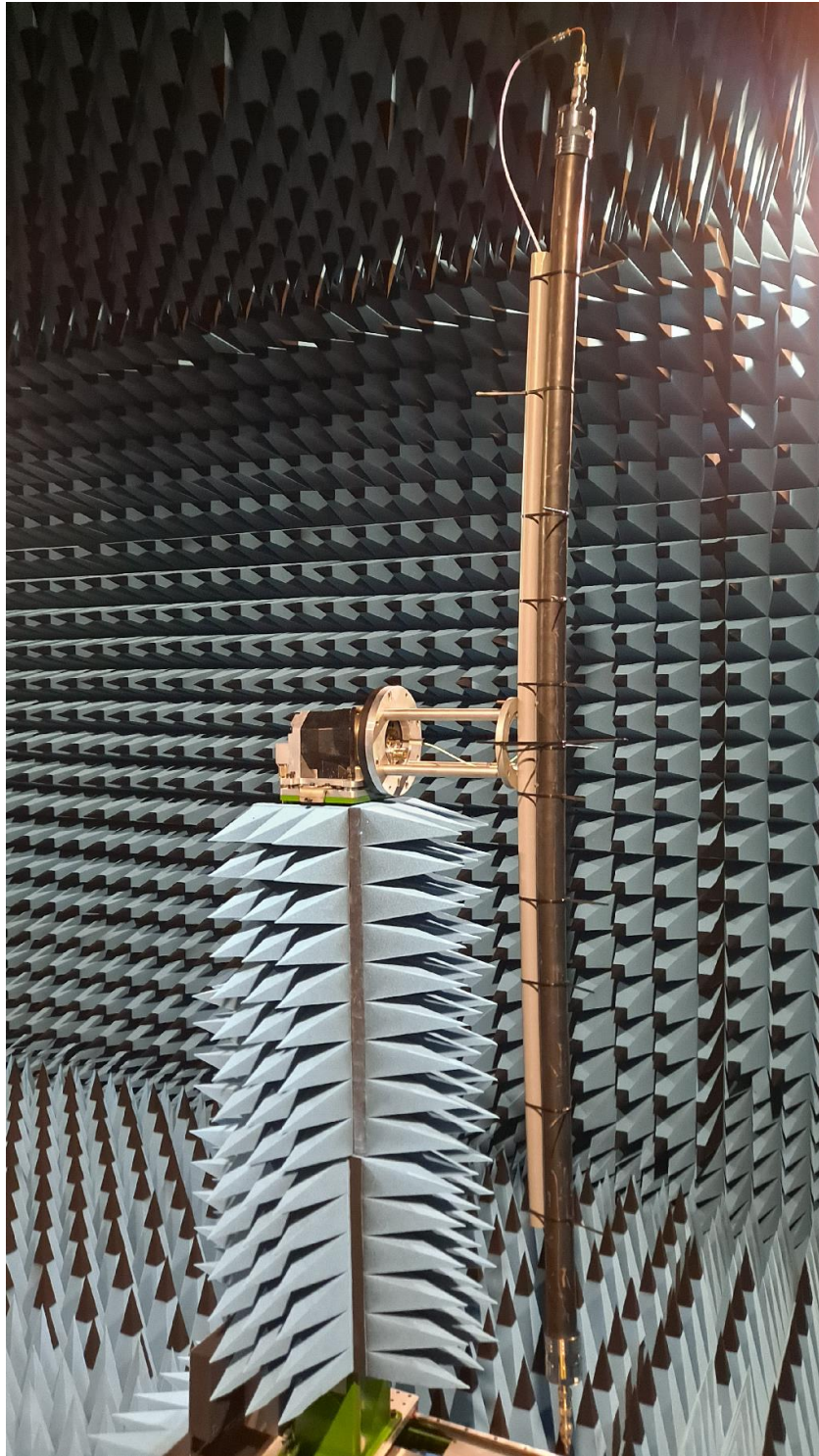
Figura 46. Segmento de 2 m de radiante colocado en el posicionador del rango esférico en cámara anecoica del grupo TSC-UNIOVI para la realización de la medida del campo radiado.
