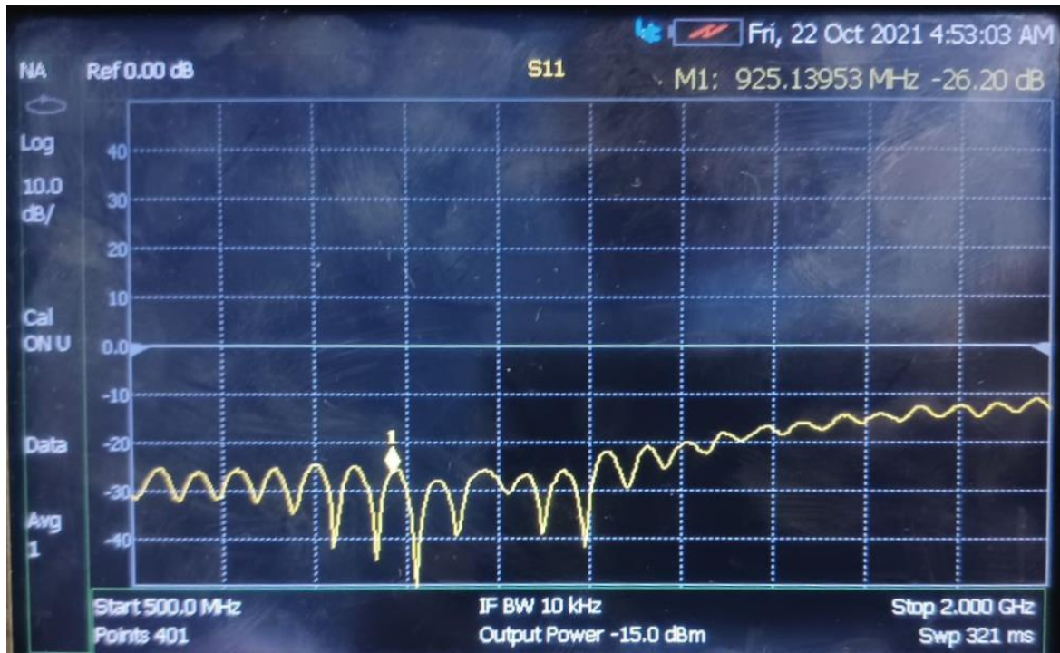
Figura 45. Medida del parámetro S_{11} del cable radiante (captura de la pantalla del analizador de espectros portátil empleado para la realización de la medida).
