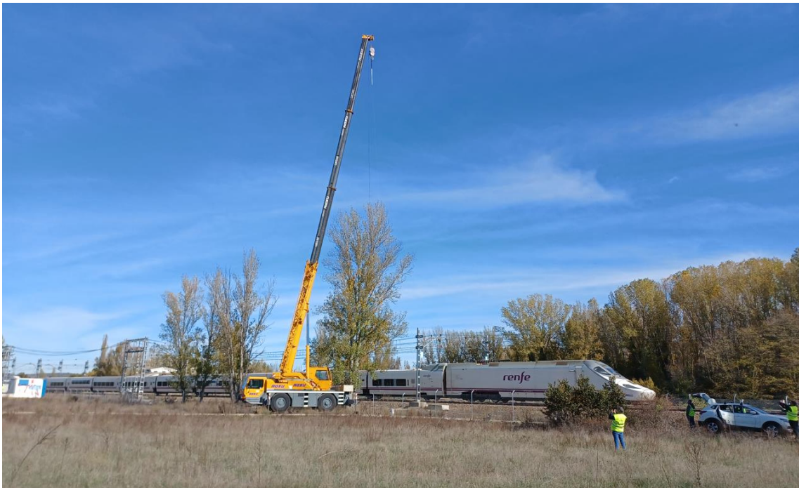
Figura 17. Fotografía de una de las campañas de medida de cobertura, con la antena situada a 35 metros.
