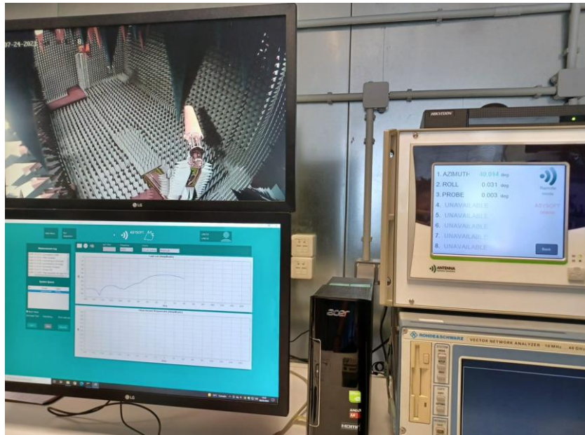
Figura 30. Vista del panel de instrumentación para el control de la cámara anecoica.
