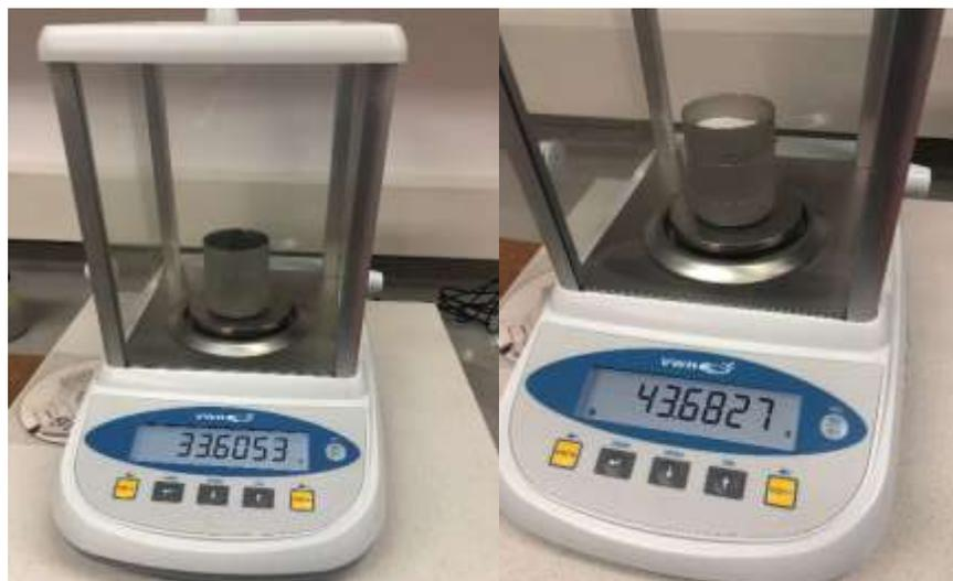
Figura 19: Tarado del porta-muestras e ingreso de la muestra a analizar.
