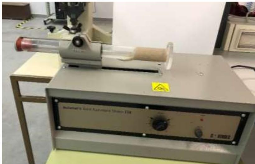
**Figura 22:** Proceso de agitado de la muestra durante 30 segundos.
