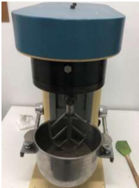
**Figura 30: Amasadora utilizada para fabricar HMAR.**
