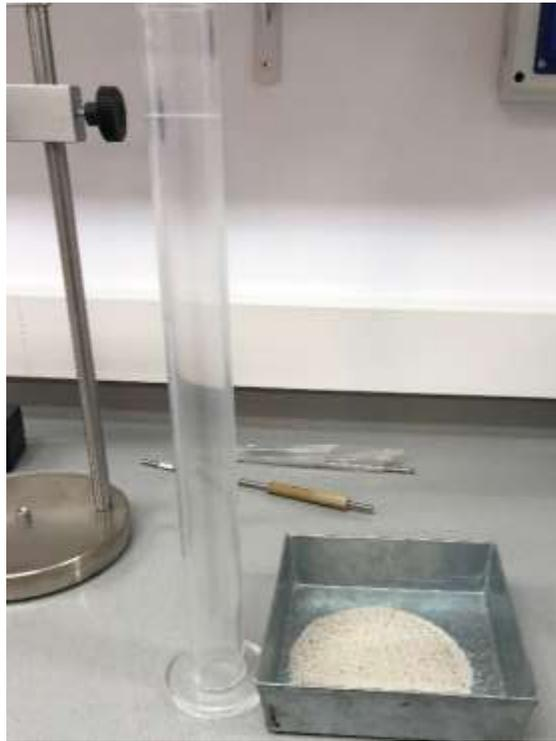
Figura 21: Peso de la muestra a ensayar antes de verter la solución.
