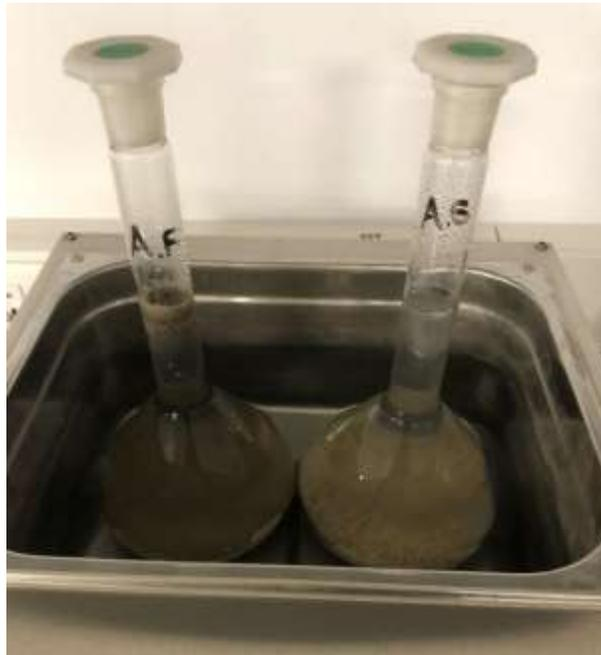
**Figura 16: Pícnómetro aforado con la muestra + agua.**
