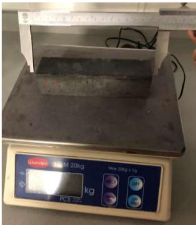
Figura 36: Toma de medidas y peso de las probetas.
