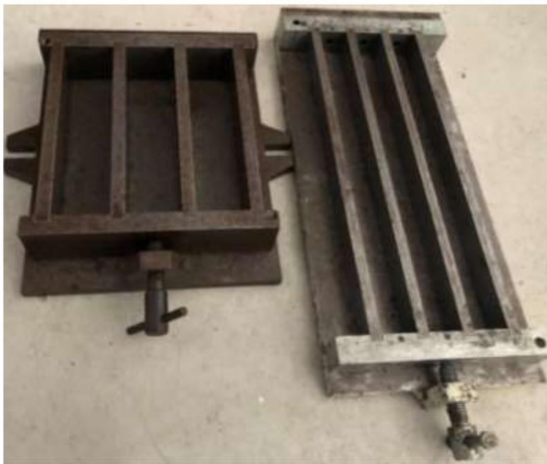
**Figura 34: Moldes para la fabricación del HMAR.**
