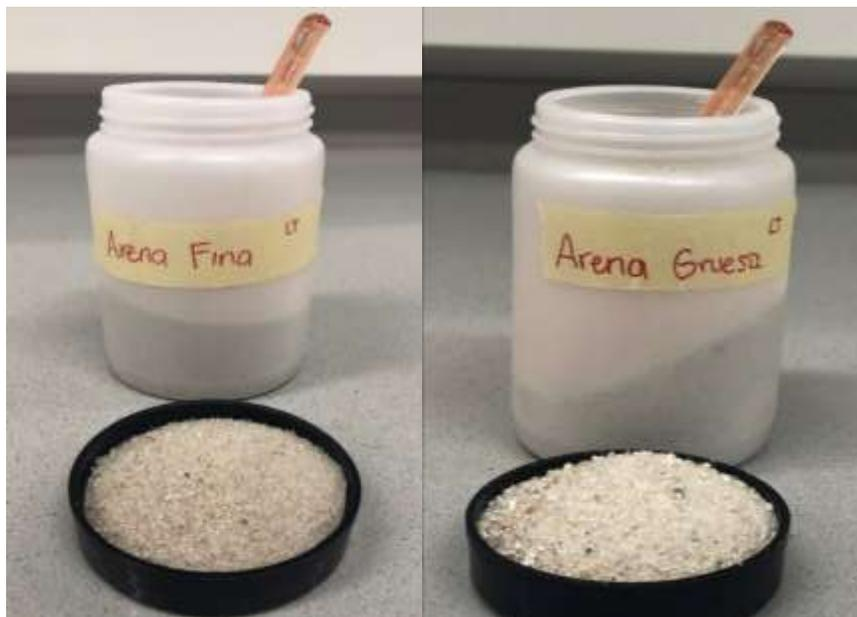
Figura 5: Arenas silíceas 0/0,5mm y 0,5/1,6mm.
