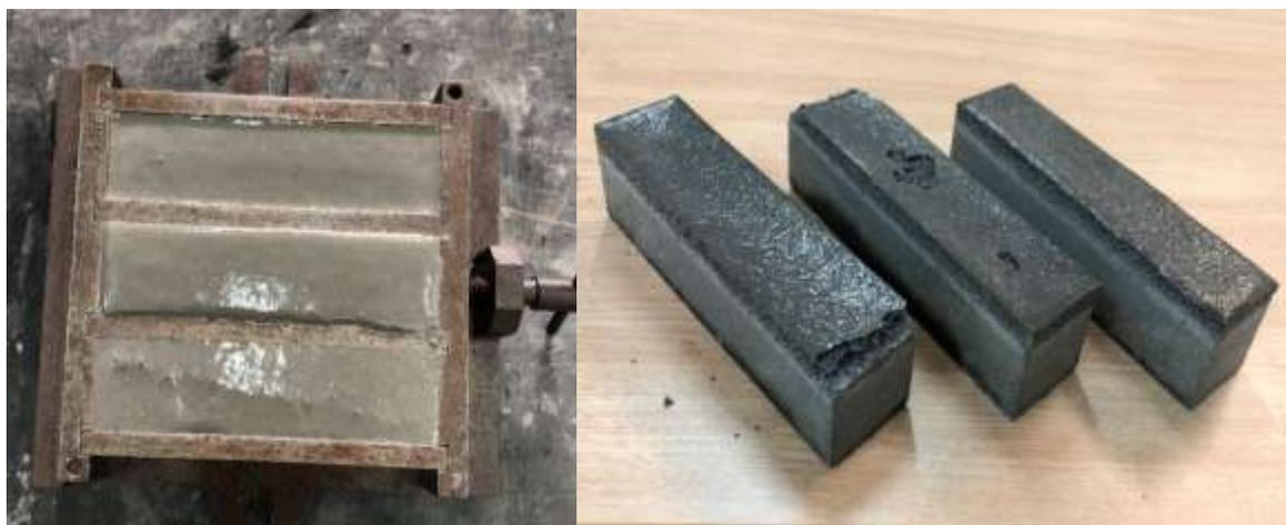
**Figura 31: Amasadas de control con exceso de agua.**
