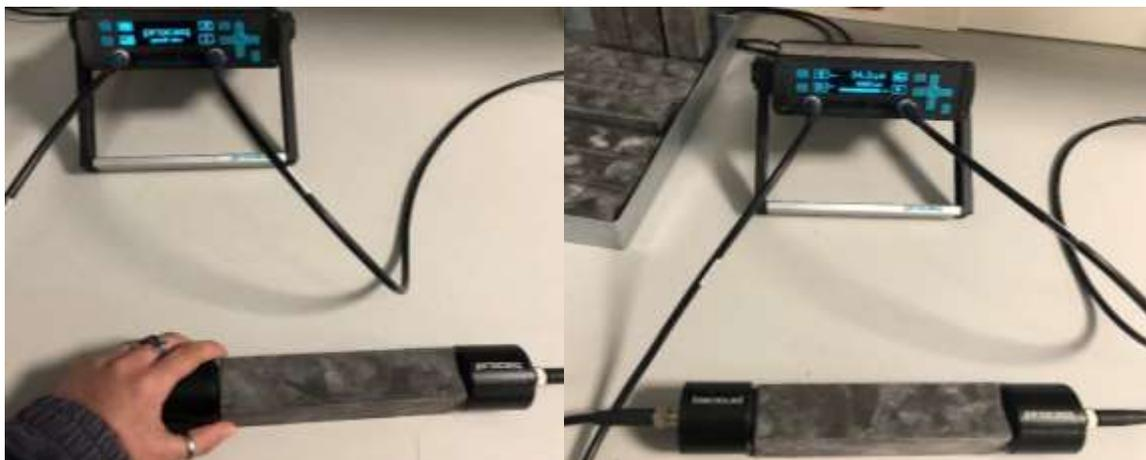
Figura 37: Procedimiento ensayo de velocidad de pulso ultrasónico.
