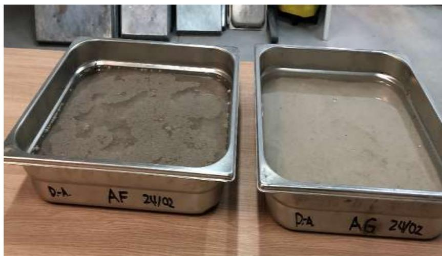
Figura 13: Muestras de arena gruesa y fina sumergidas en agua por 24 horas.
