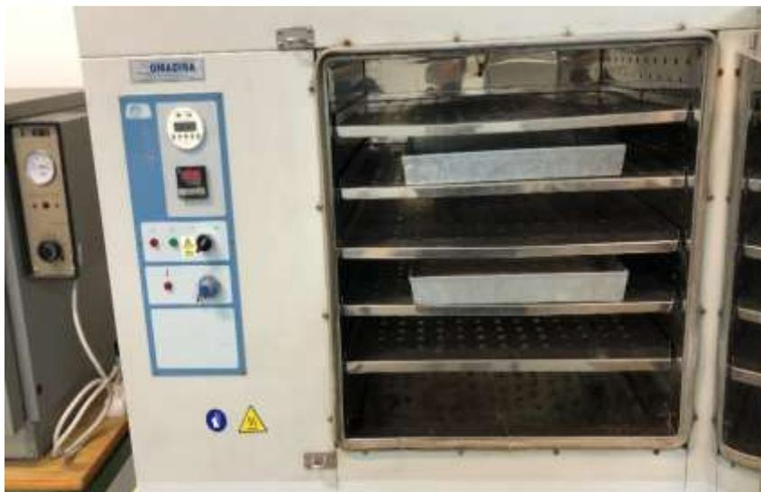
Figura 18: Secado muestras hasta masa constante.
