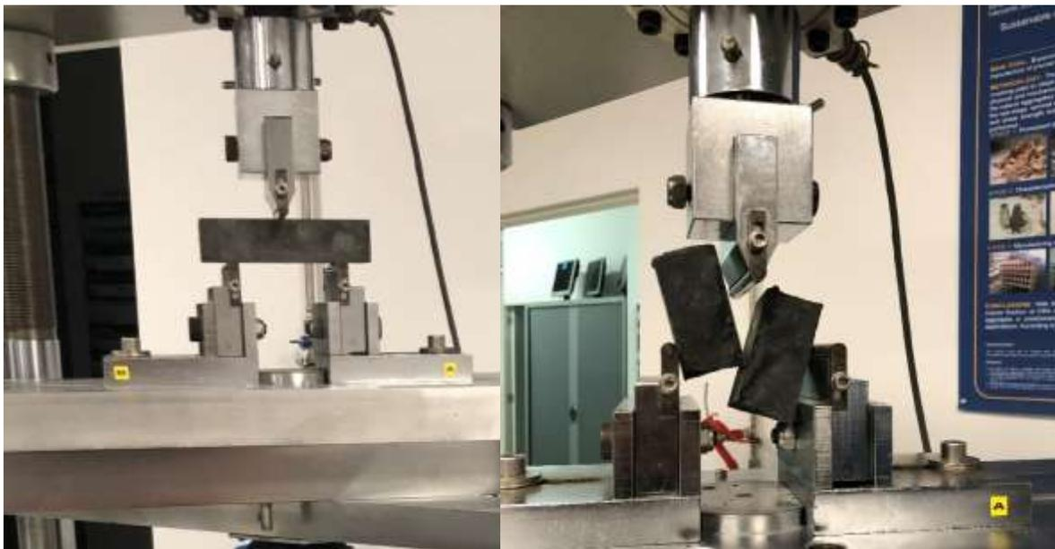
Figura 39: Probeta antes y después del ensayo a flexión.
