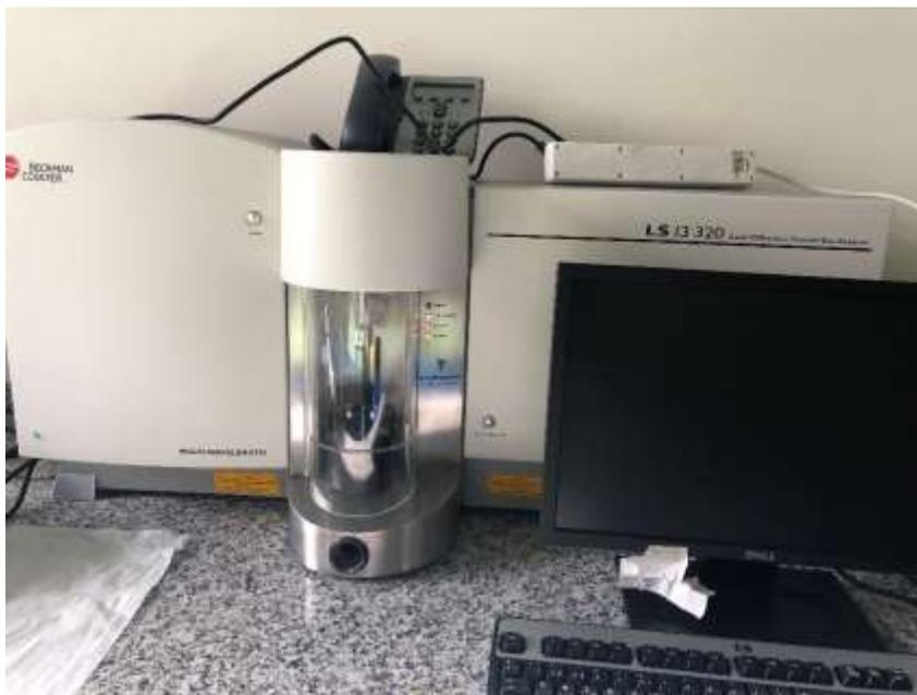
**Figura 28: Equipo de difracción laser.**
