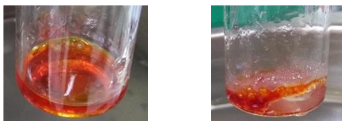
Figura 5. Imágenes de la reacción 60 min después de la adición de n\text{BuLi} sobre la mezcla de estireno y DES (1 ChCl /2 Gli ) a diferentes concentraciones iniciales de estireno (izquierda = 5 mol/L; derecha = 10 mol/L).
