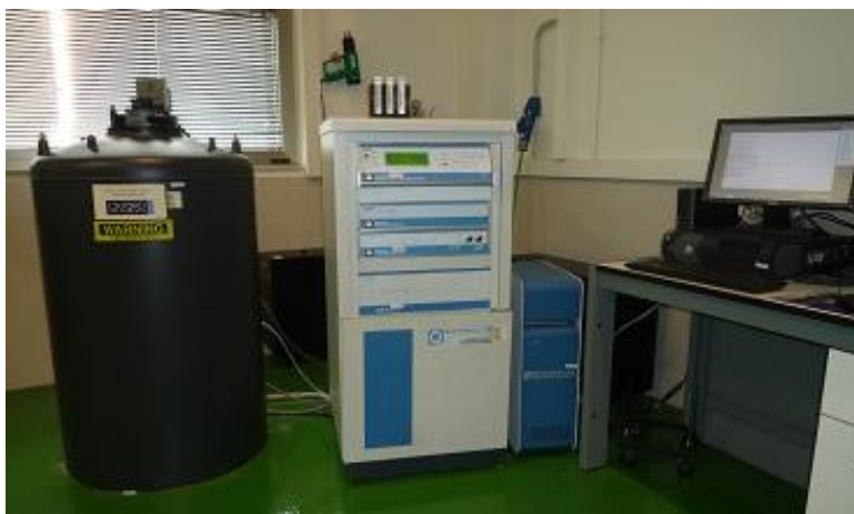
Figura 6.2: PPMS-14T disponible en los Servicios Científico-Técnicos de la Universidad de Oviedo. Recuperado de: [50].
