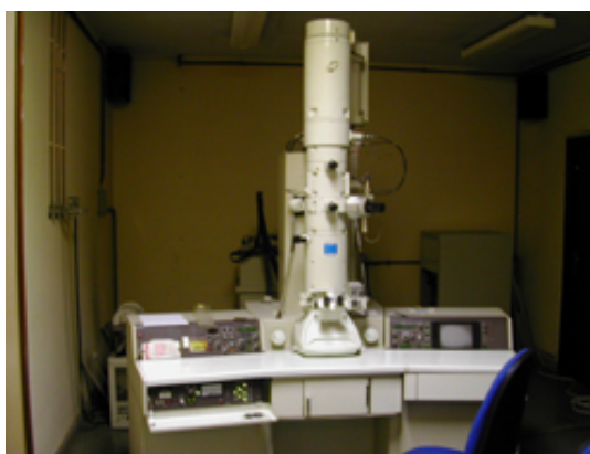
Figura 5.2: JEOL-2000 Ex-II disponible en los Servicios Científico-Técnicos de la Universidad de Oviedo. Recuperado de: [42].
