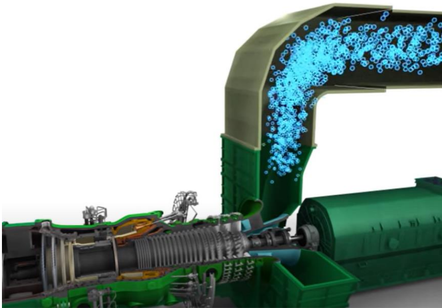
Ilustración 2.2. Entrada de aire (fuente: [4])
