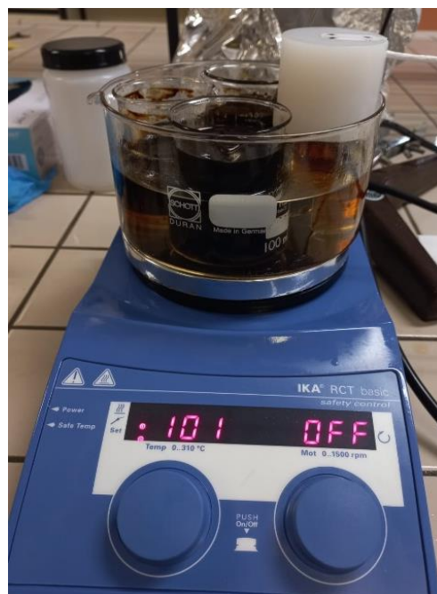
Figura 15: Baño térmico sobre placa calefactora para las medidas de conductividad.
