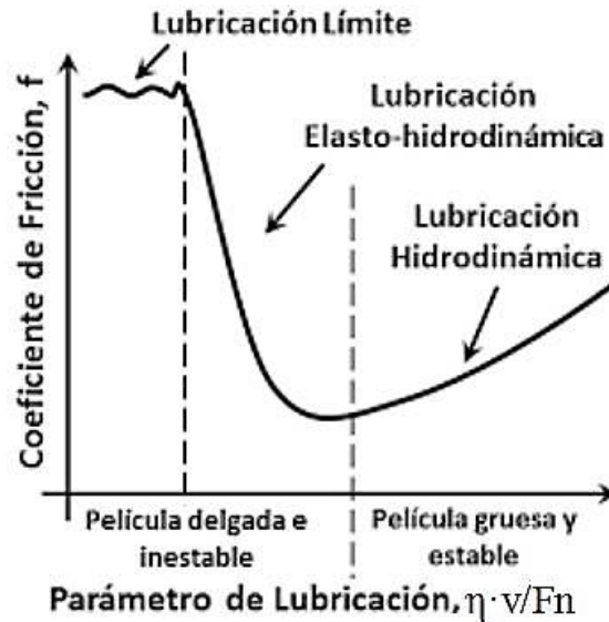
Figura 5: Curva de Stribeck y los diferentes regímenes de lubricación [18].
