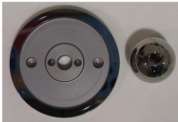
Figura 16: Probetas de ensayo de la MTM: Disco Estándar (Izquierda), Bola Perforada (Derecha).
