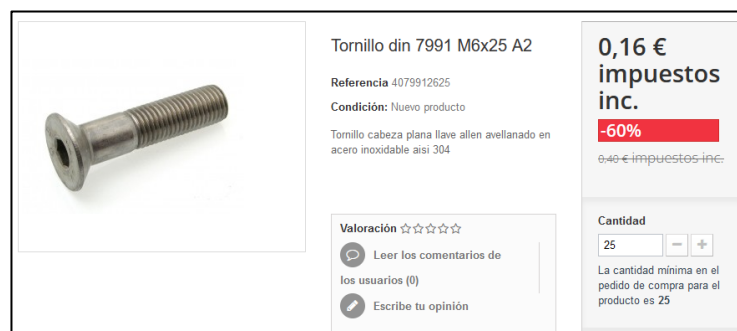
Figura 6.58. Selección tornillo DIN 7991 M6x25
