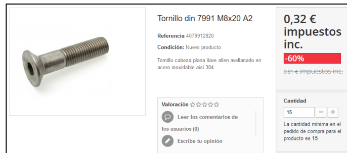
Figura 6.57. Selección tornillo DIN 7991 M8x20
