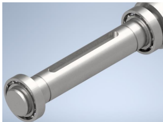
Figura 5.13. Rodamientos insertados en el primer eje accionado
