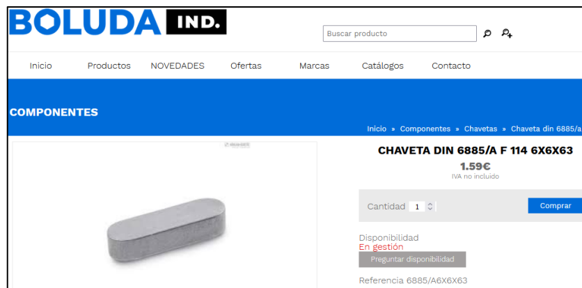
Figura 6.36. Selección de la chaveta para los engranajes y las poleas pequeñas (DIN 6885-A 6x6x63)
