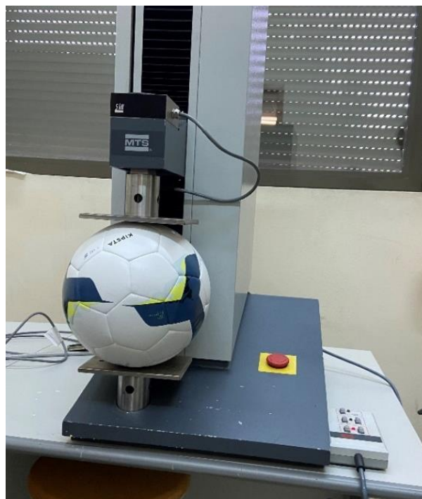
Figura 4.7. Ensayo de compresión en pelota de fútbol
