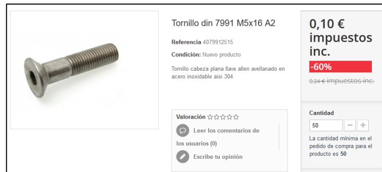
Figura 6.59. Selección tornillo DIN 7991 M5x16
