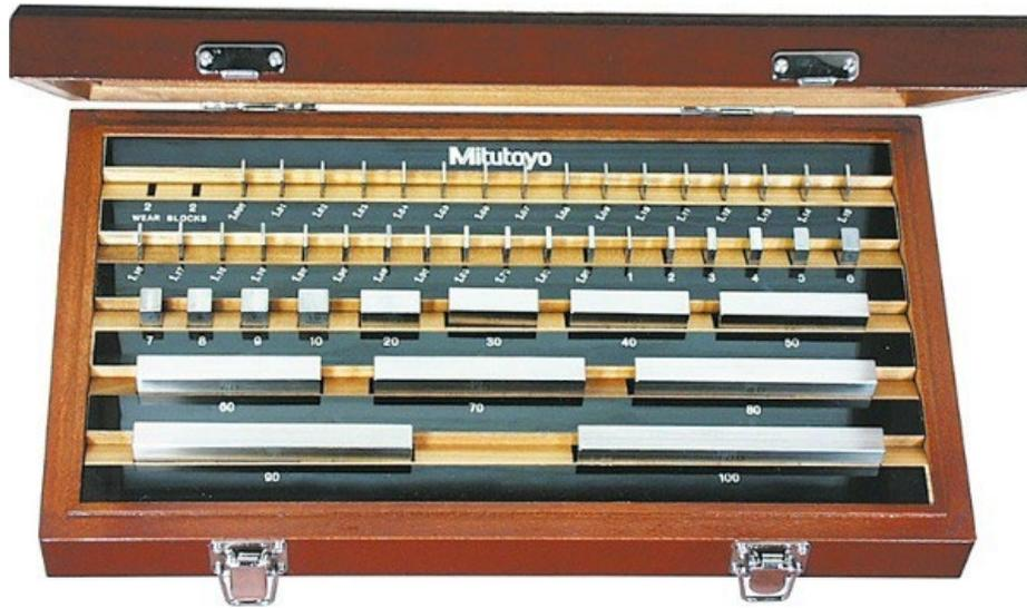
*Ilustración 4.20. Juego de bloques patrón del fabricante Mitutoyo*
