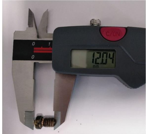
*Ilustración 5.21. Disminución de la longitud de boquilla debido al desgaste*
