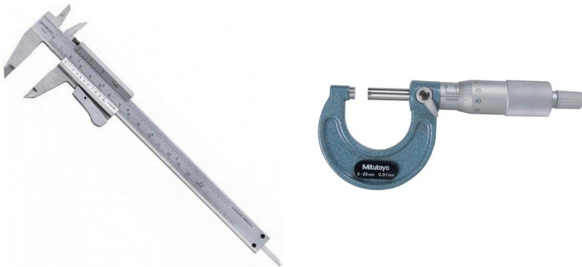
*Ilustración 4.19. Instrumentos de medida clase A*
