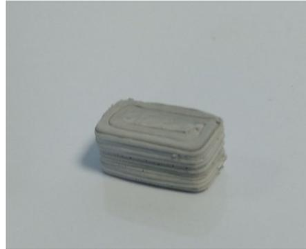
*Ilustración 5.15. Prisma impreso en alúmina*
