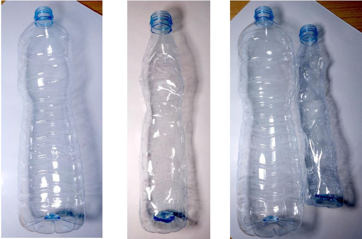
Ilustración 5.23. Procedimiento térmico para la preparación de botellas de plástico
