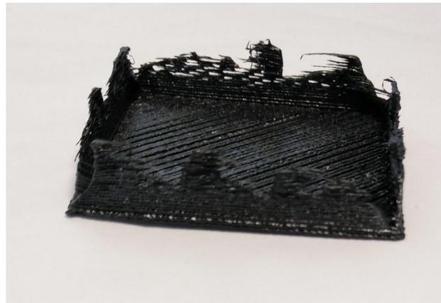
*Ilustración 5.19. Primera probeta de cubo vacío en Luvocom*
