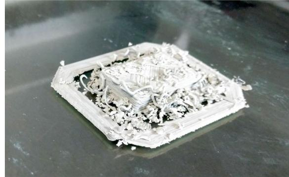
*Ilustración 5.16. Fabricaciones fallidas de prismas en alúmina*
