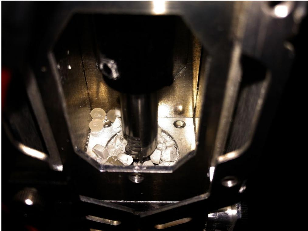
*Ilustración 5.14. Atascos por alúmina pulverulenta*
