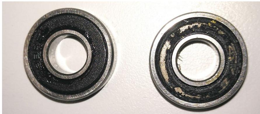
Ilustración 5.11. Estado de desgaste de los rodamientos
