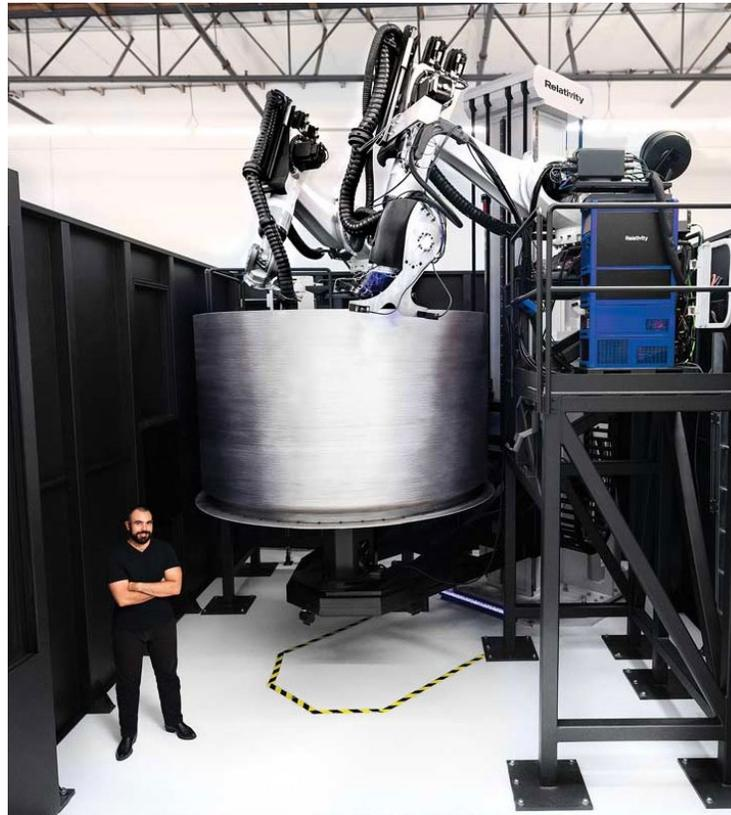
*Ilustración 2.14. Impresión 3D de un cohete por la empresa Relativity Space [48]*
