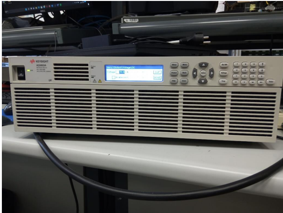
Figura 5.13. Fuente de alimentación AC6803A, utilizada para generar los 15V de entrada del convertidor.
