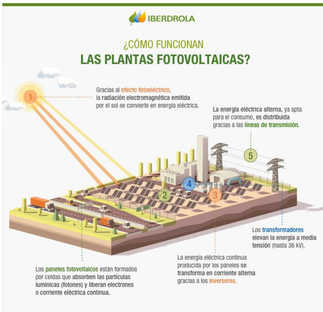
Figura 4. Funcionamiento de una Planta Fotovoltaica.
