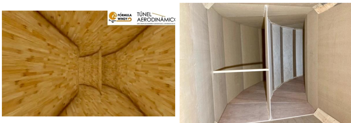
Figura 24. Difusor 2 en curva, con la guía central.
