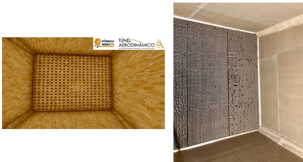
Figura 21. Cámara de remanso y “honeycomb”.
