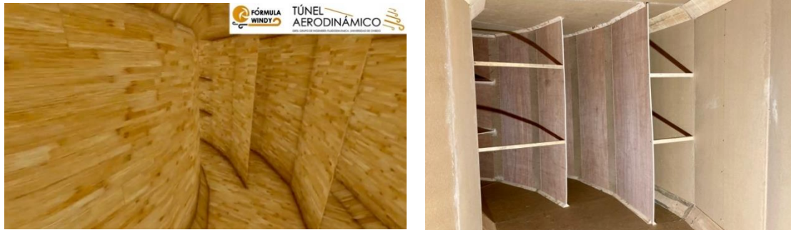
Figura 19. Guías en la curva a la entrada del difusor 1.
