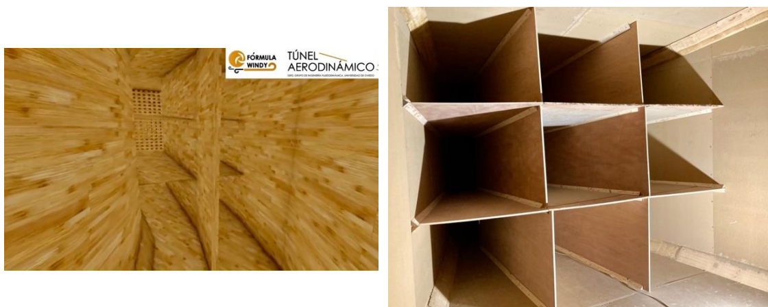
Figura 20. Enderezador 2 en el difusor 1.
