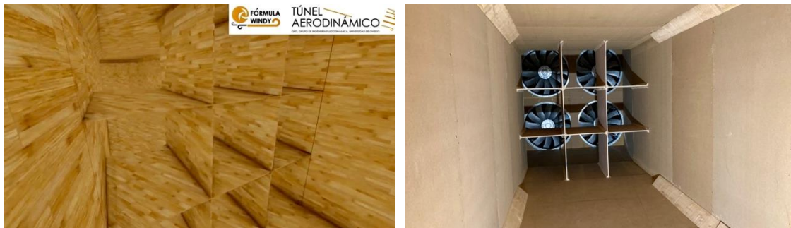
Figura 17. Enderezador 1 a la salida de los ventiladores.
