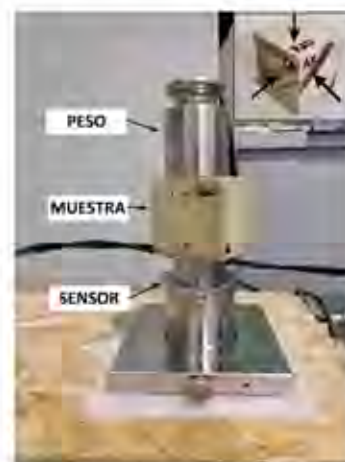
Figura 2. Medición de conductividad térmica sobre una de las muestras
