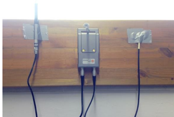
Figura 9: Termohigrógrafo con sonda de temperatura superficial en escuadría de madera.
