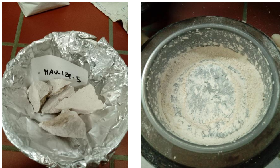
Figura D.4. Imagen de la muestra de chalkstone antes y después de su molienda en el molino de anillos.
