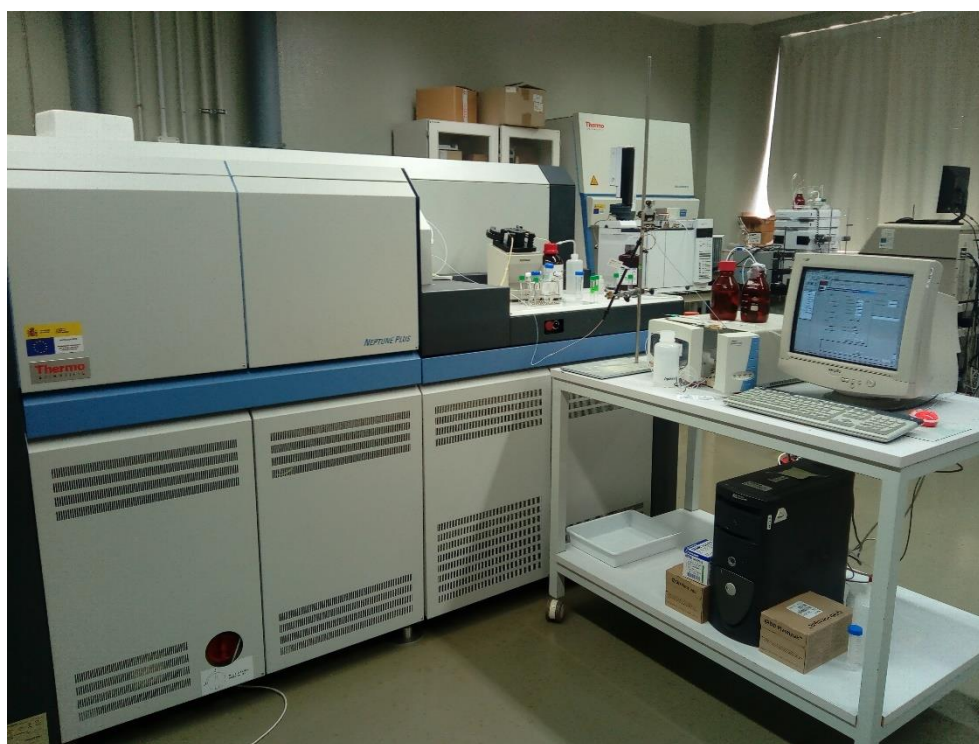
Figura C.4. Fotografía del acoplamiento del sistema Surveyor LC al MC- ICP-MS multicolector Neptune Plus .
