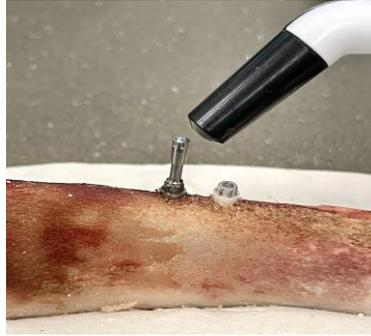
**FIGURA 20.** Imagen del Penguin RFA con un Multipeg colocado en un implante insertado en costilla fresca de vaca.
