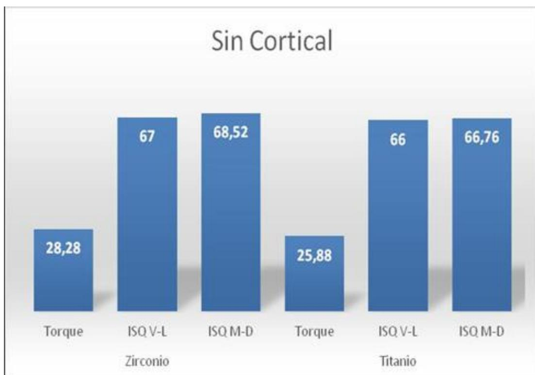
**FIGURA 26.** Diagrama de barras comparando valores promedio de ISQ y torque de inserción de implantes de Ti y Zr en el bloque de resina sin cortical.
