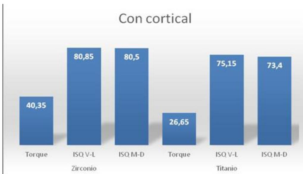
**FIGURA 27.** Diagrama de barras comparando valores promedio de ISQ y torque de inserción de implantes de Ti y Zr en el bloque de resina con cortical.
