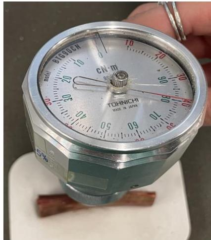
**FIGURA 19.** Vista del torquímetro analógico previamente calibrado BTG90CN (Tohnichi, Tokio, Japón).
