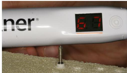
**FIGURA 14.** Medición de estabilidad con el aparato de análisis de frecuencia de resonancia Penguin y vista de un valor ISQ.
