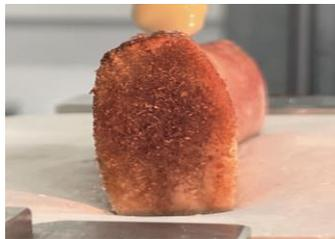
**FIGURA 17.** Costilla de origen bovino embebida en modelo de escayola y preparada para recibir el implante correspondiente
