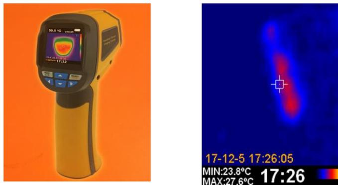
**FIGURAS 15 y 16.** Imagen de la cámara térmica y del resultado de la medición de la temperatura al colocar los implantes.
