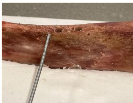
**FIGURA 21.** Vista de la costilla con los lechos de los implantes y la sonda de sensores térmicos Cu/Ni.
