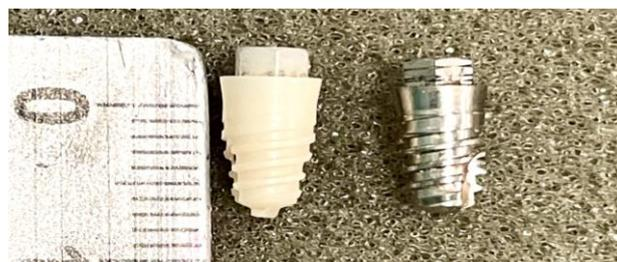
**FIGURA 18.** Aspecto de los implantes Klockner SK2 de hexágono externo fabricados en circonia (izda) y titanio (dcha) , con su correspondiente cuello pulido.
