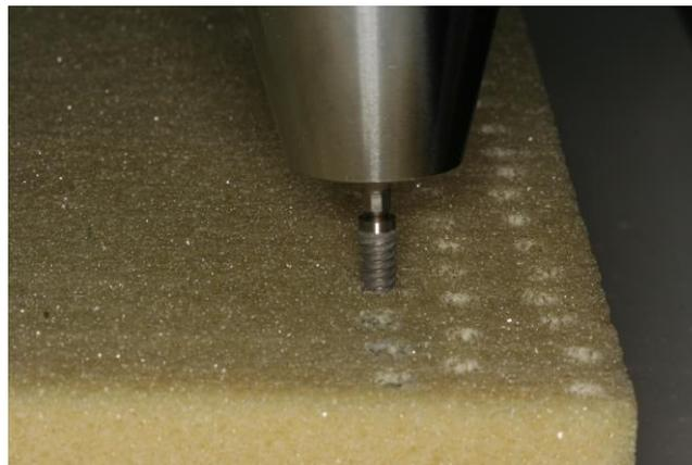
**FIGURA 13.** Colocación del implante en el bloque de resina con el torquímetro de Tohnichi (Tokio, Japón)
