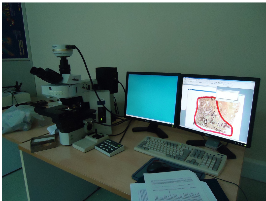
Figura 11. Microscopio de fluorescencia Olympus BX61 en el equipo de estereología CAST2.
