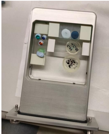
Ilustración 6: Muestras depositadas en el interior de la celda de ablación, antes de ser colocada en el dispositivo experimental para su estudio.
