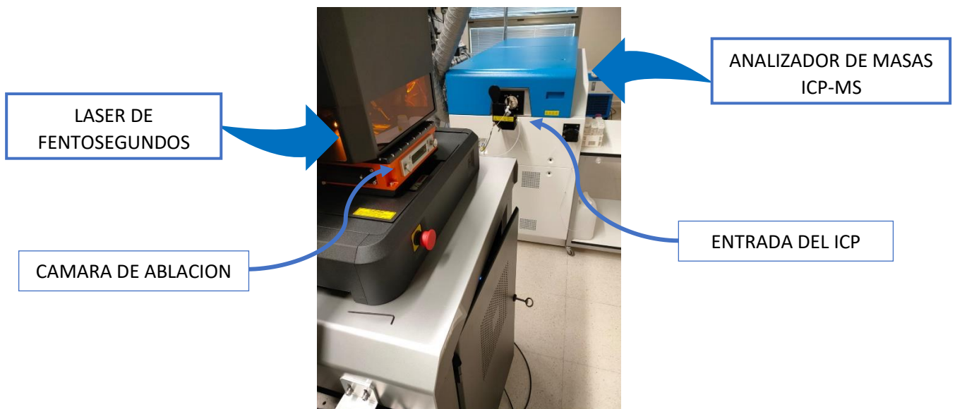
Ilustración 23: Dispositivo experimental LA-ICP-MS empleado en el trabajo, indicando las partes principales de este.
