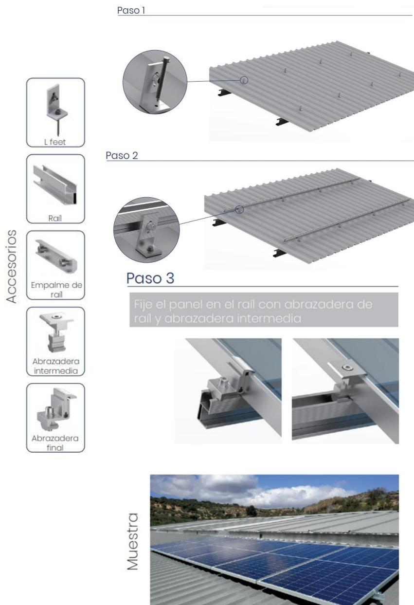
Figura 4.3. Proceso de montaje de la estructura soporte [37]
