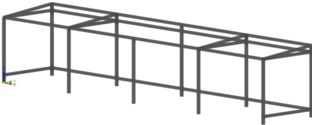
Figura 4.15. Representación de la estructura final comprobada de la futura marquesina[44]
