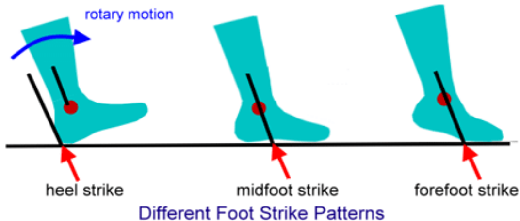
Figura 1.2.- Esquema con los diferentes tipos de contacto que puede realizar el pie con la superficie durante la carrera. De izquierda a derecha RFS, MFS y FFS. Fuente: [2].
