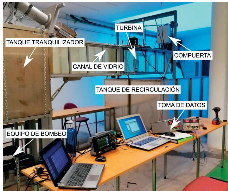
Figura 5 | Túnel hidrodinámico de la EPM de la Universidad de Oviedo.
