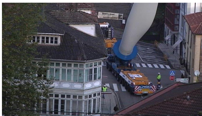
Ilustración 31. Transporte vertical palas en Ayande.
