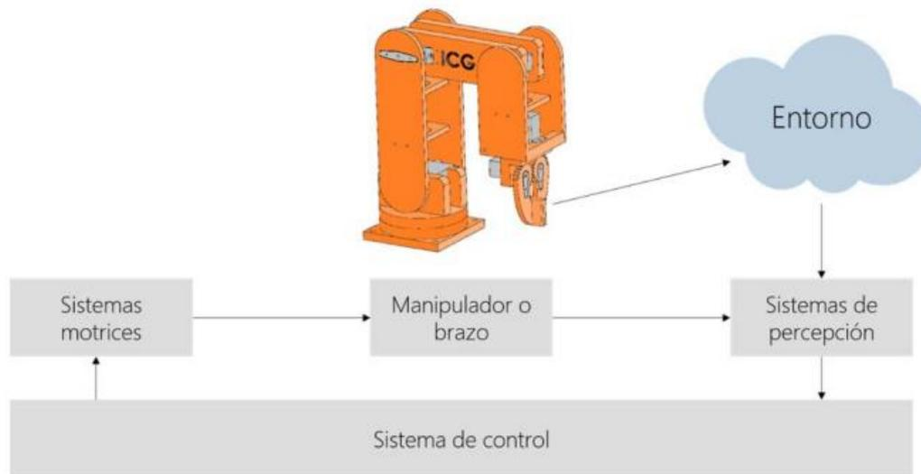
Ilustración 8. Subsistemas de un brazo robótico
