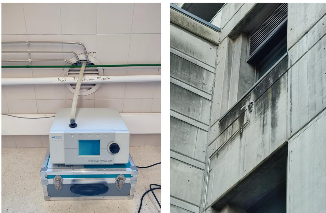
(a) Fotografía del APS en el laboratorio del Departamento de Aerosoles Atmosféricos de la Universidad de Oviedo en Mieres. La tubería de goma se lleva al exterior a través de una rejilla de ventilación.
