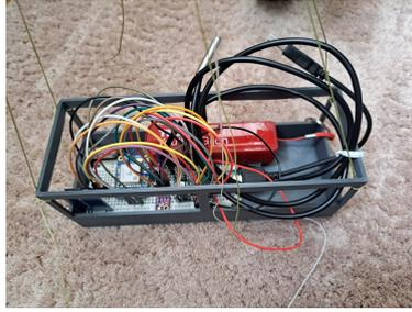
Figura 4.2: Fotografía del circuito que se colgó al globo para medir los perfiles verticales de la atmósfera.
