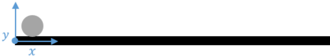
Figura 4.1: Diagrama del sistema de ball and beam
