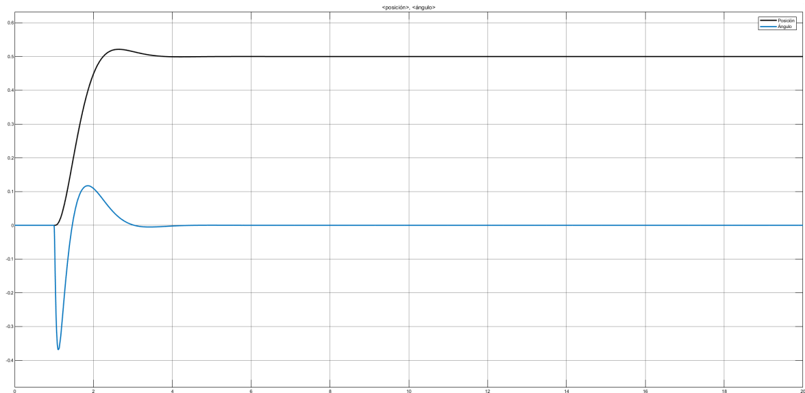
Figura 5.6: Simulación del ángulo y posición usando un controlador rápido en el ball and beam
