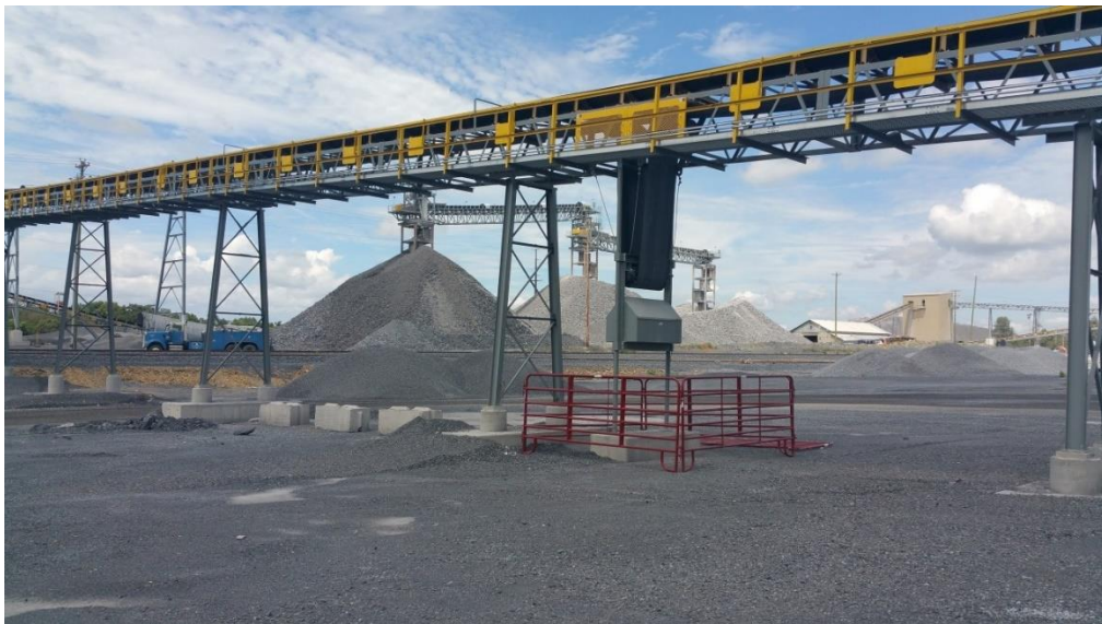
Ilustración 8. Sistema de tensado por medio de contrapeso. Fuente: https://esm.skemachinery.com/f729222/faq-detail.htm
