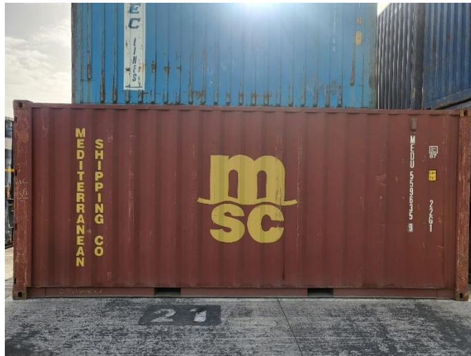
Imagen 3: Contenedor estándar de 20’x8’x8’,6” (con respiraderos pasivos en la parte superior del espacio de carga) – Propia
