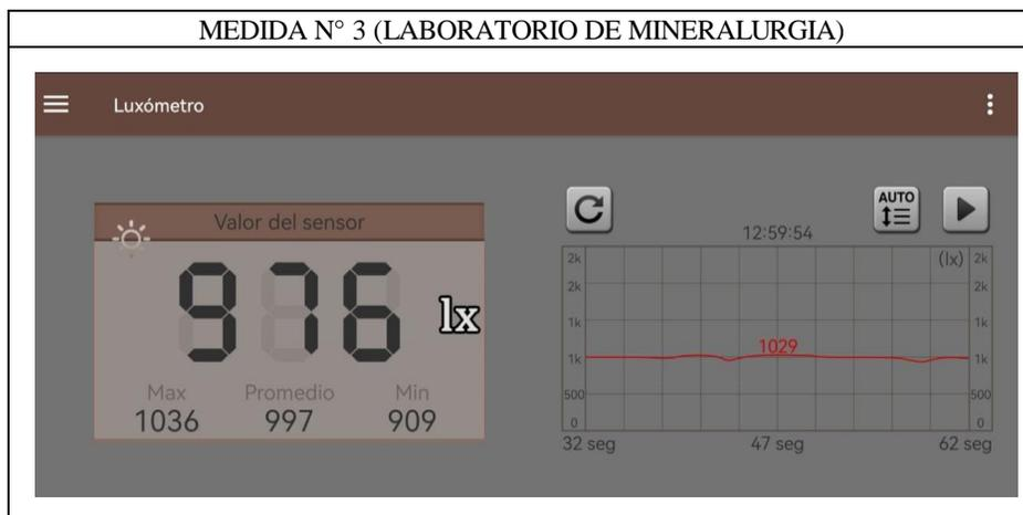
**ANEXO 25. Medida del Luxómetro en el punto N°3 del laboratorio de Metalurgia (mineralurgia) (Aplicación de móvil).**
