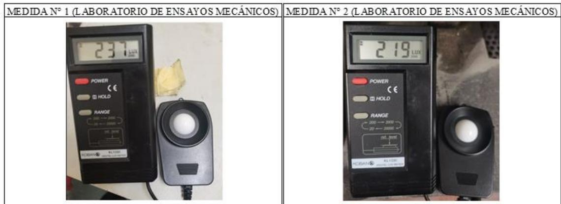
**ANEXO 49. Medida del Luxómetro de mano en el punto N°1 y N°2 del laboratorio de Ensayos mecánicos de materiales.**
