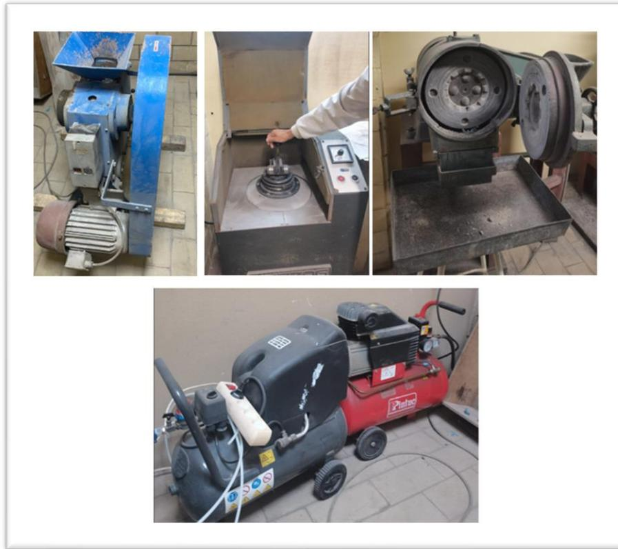
***ANEXO 5. Maquinaria Utilizada en el Laboratorio de Metalurgia (mineralurgia) para la fabricación de simulantes lunares.***
