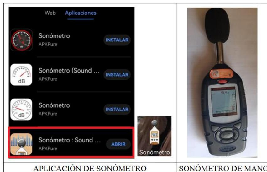
**Figura 15.** Aplicación de sonómetro utilizada para las medidas de ruido de los laboratorios y el sonómetro de mano.
