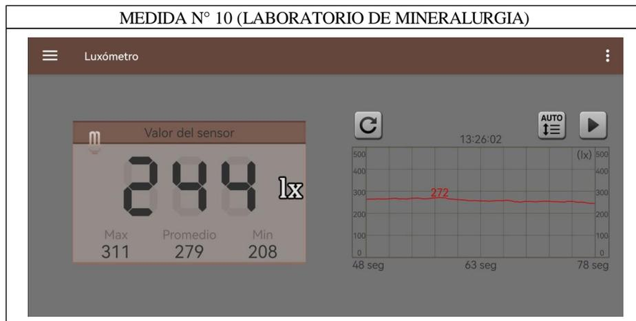
**ANEXO 32. Medida del Luxómetro en el punto N°10 del laboratorio de Metalurgia (mineralurgia) (Aplicación de móvil).**
