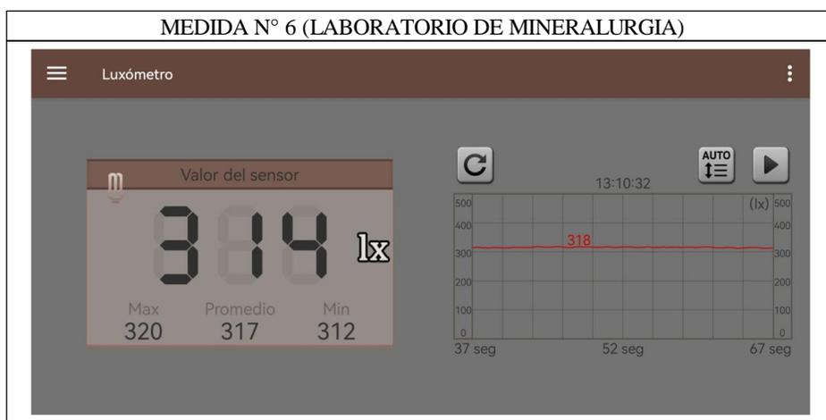
**ANEXO 28. Medida del Luxómetro en el punto N°6 del laboratorio de Metalurgia (mineralurgia) (Aplicación de móvil).**
