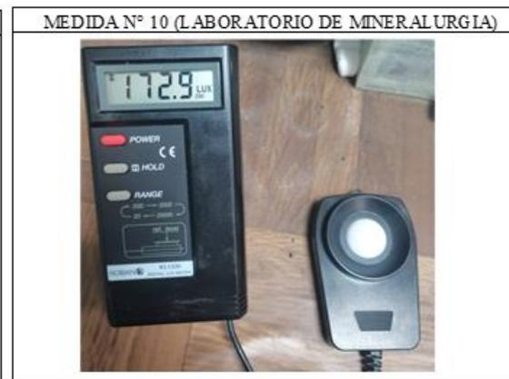
**ANEXO 40. Medida del Luxómetro de mano en el punto N°9 y N°10 del laboratorio de Metalurgia (mineralurgia).**
