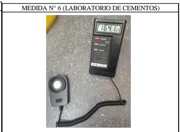
*ANEXO 22. Medida del Luxómetro de mano en el punto N°5 y N°6 del laboratorio de cementos.*
