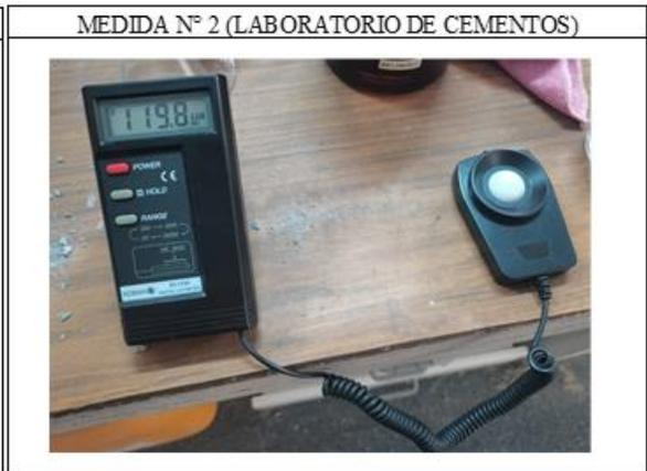
*ANEXO 20. Medida del Luxómetro de mano en el punto N°1 y N°2 del laboratorio de cementos.*
