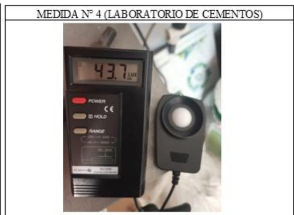
*ANEXO 21. Medida del Luxómetro de mano en el punto N°3 y N°4 del laboratorio de cementos.*
