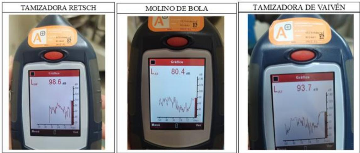
**ANEXO 58.** Medida del Sonómetro de mano en la tamizadora Retsch, Molino de bola y tamizadora de Vaivén del laboratorio de Ensayos mecánicos de materiales.
