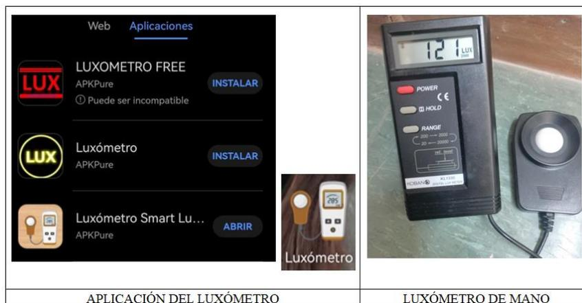
Figura 16. Aplicación del Luxómetro utilizado para las medidas de iluminación de los laboratorios y el Luxómetro de mano.
