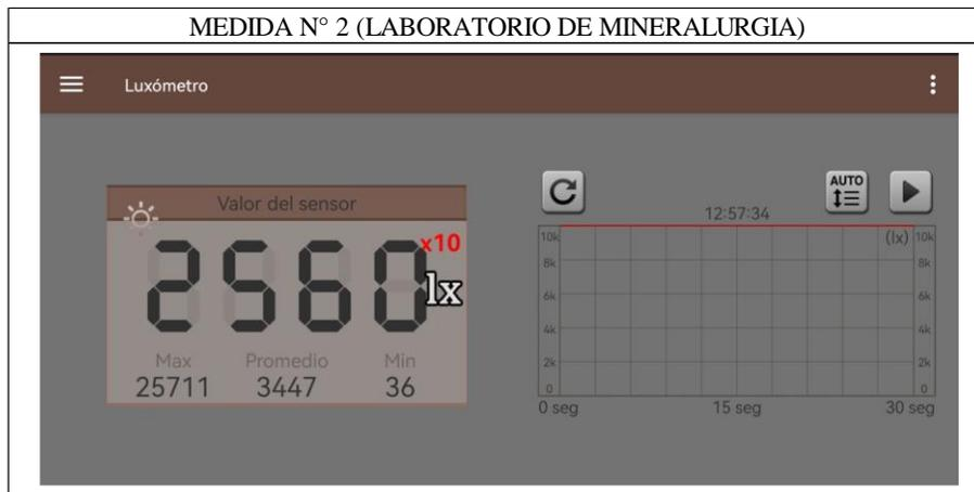
**ANEXO 24. Medida del Luxómetro en el punto N°2 del laboratorio de Metalurgia (mineralurgia) (Aplicación de móvil).**
