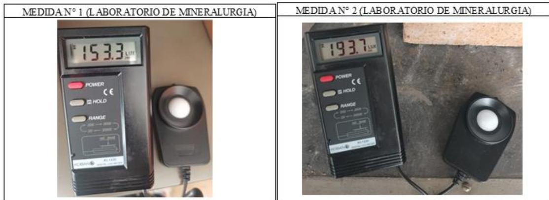
**ANEXO 36. Medida del Luxómetro de mano en el punto N°1 y N°2 del laboratorio de Metalurgia (mineralurgia).**
