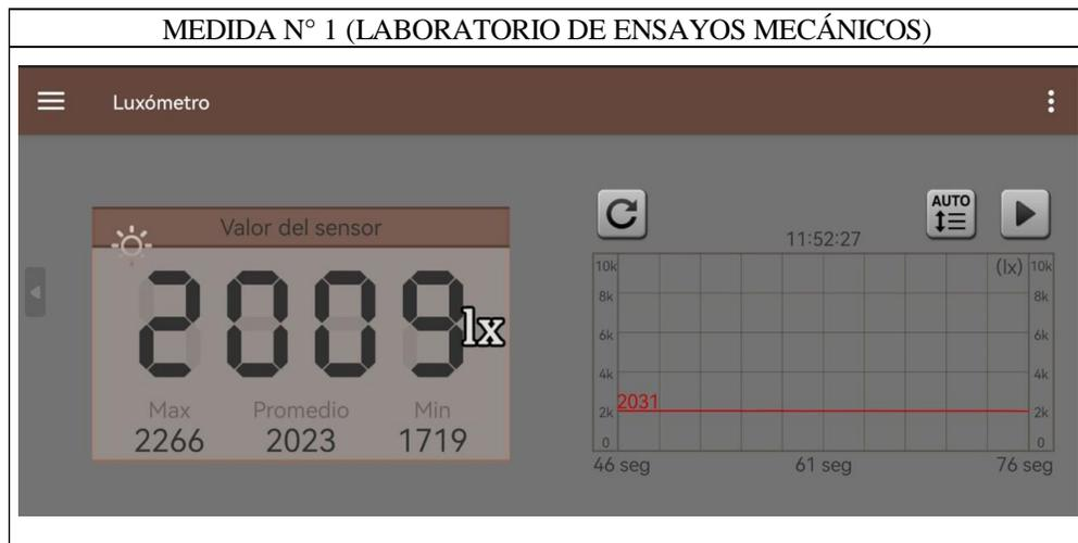
**ANEXO 43. Medida del Luxómetro en el punto N°1 del laboratorio de Ensayos mecánicos de materiales (Aplicación de móvil).**
