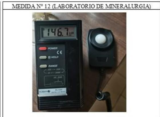
**ANEXO 41. Medida del Luxómetro de mano en el punto N°11 y N°112 del laboratorio de Metalurgia (mineralurgia).**
