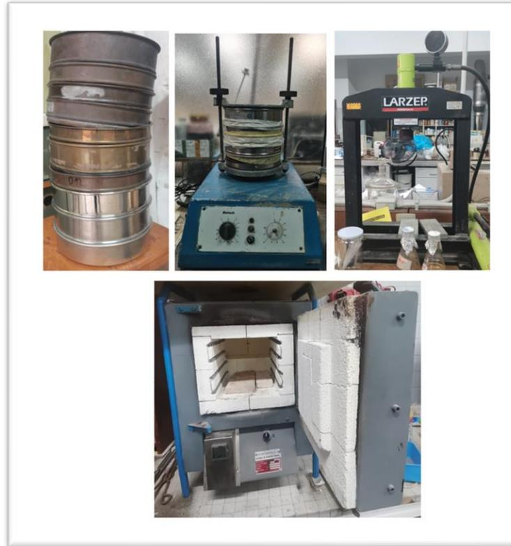
*ANEXO 3. Maquinaria Utilizada en el Laboratorio de Cementos para la fabricación de simulantes lunares.*
