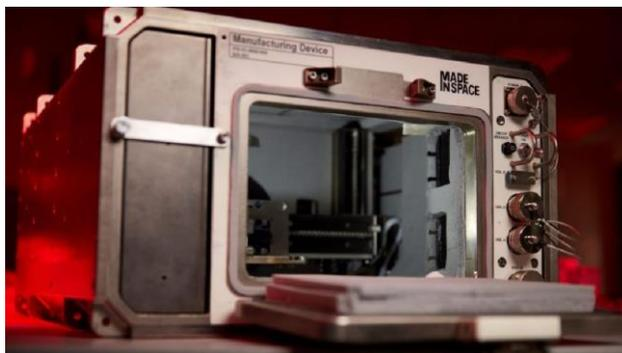
*Figura 5. Impresora en 3D Redwire que emplea el polvo lunar y regolito del planeta rojo para que los astronautas fabriquen sus propias herramientas y estructuras (Hernando, 2021).*
