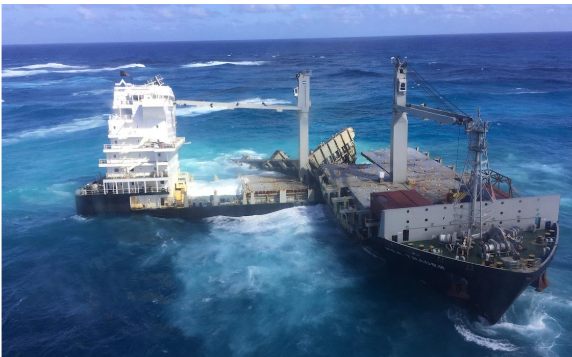
Ilustración 68: Foto del buque Kea Trader partido a la mitad debido a los golpes de mar. Fuente: medium.com
