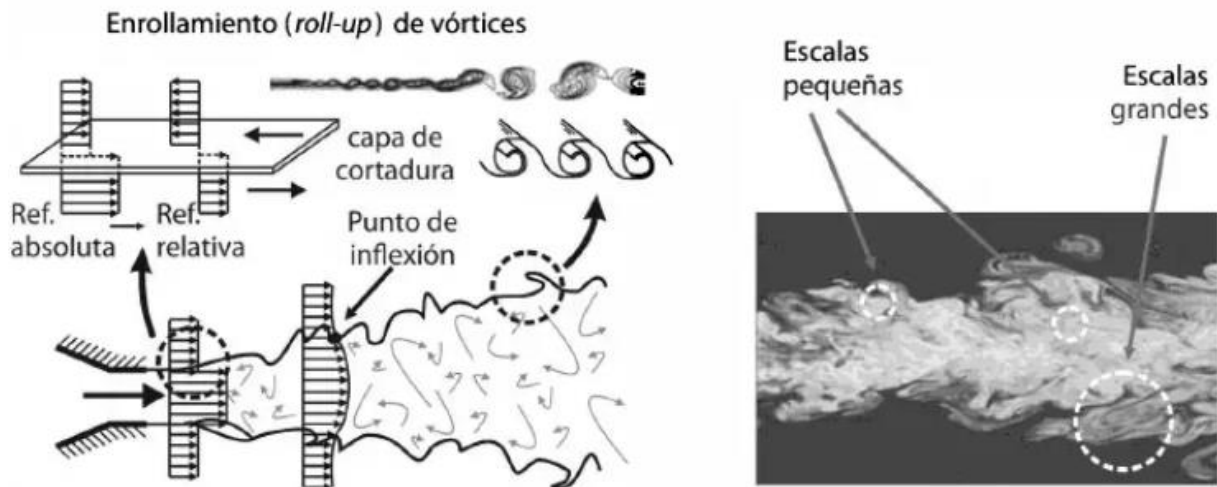
Figura 2.13 Transición en un chorro turbulento. (a) Inestabilidades en la capa de cortadura. (b) Visualización de un chorro turbulento (Fernández Oro, 2012)
