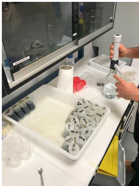
FIGURA 11: PREPARACIÓN DE LA MEZCLA DE LAS MUESTRAS CON LA SOSA CÁUSTICA
