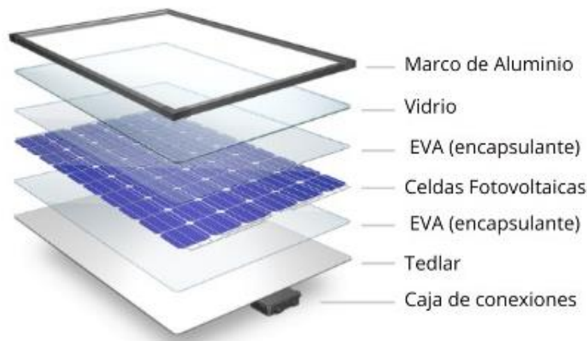
Figura 4.15. Estructura de los paneles solares.
