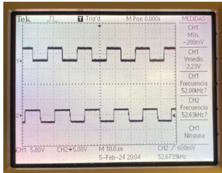
Figura 8.13 - Lectura en el osciloscopio de la frecuencia de la prueba del encoder.
