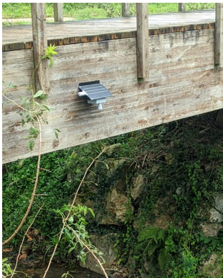
Ilustración 47 Despliegue del dispositivo encargado de medir el nivel del río (MediaLab - LPWAN)
