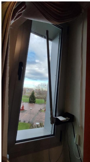
Ilustración 19 Instalación del gateway indoor , MediaLab
