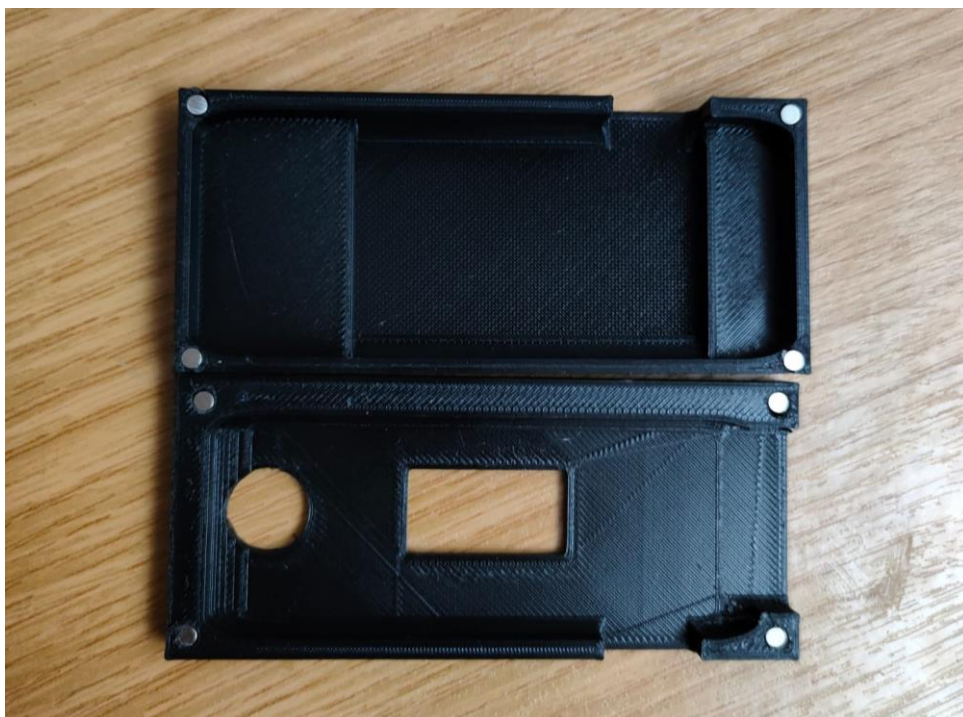
Ilustración 26 Prototipo de carcasa impresa en 3D, las dos partes son vistas por dentro
