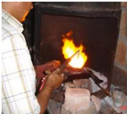
**Figura 41.** Proceso de “quema” de una amalgama de Hg y oro.
