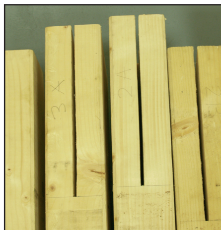
Figura 2. Cajeados para unión con pieza de contrachapado y con herraje metálico. Figure 2. Grooves for birch plywood inserts and steel truss plates.
