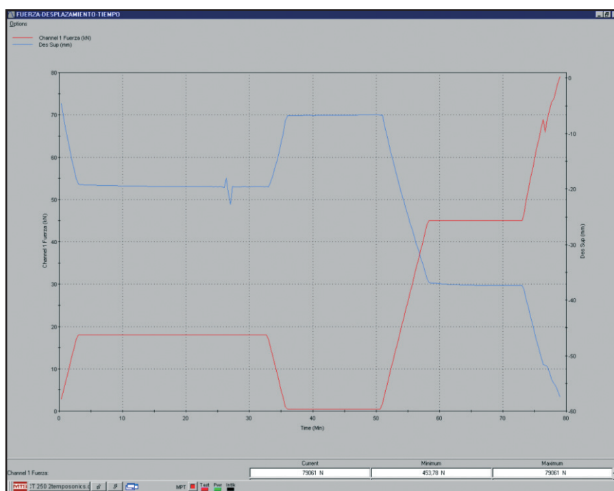
Figura 4. Gráficos carga-tiempo y desplazamiento-tiempo para el protocolo de ensayo. Figure 4. Load-time and displacement-time graphs for the test protocol.
