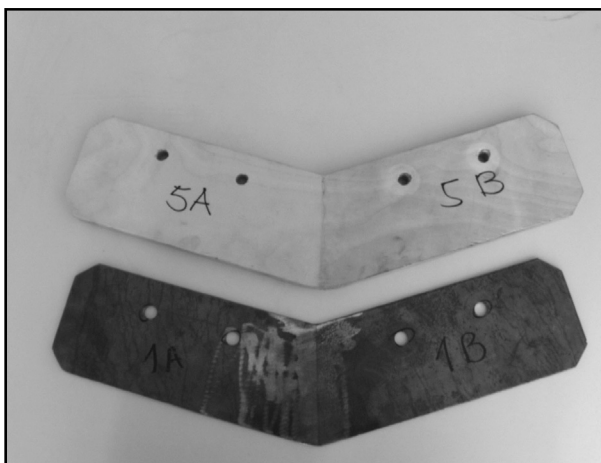
Figura 1. Pieza de unión de contrachapado de abedul y herraje metálico. Figure 1. Birch plywood insert and steel truss plate.
