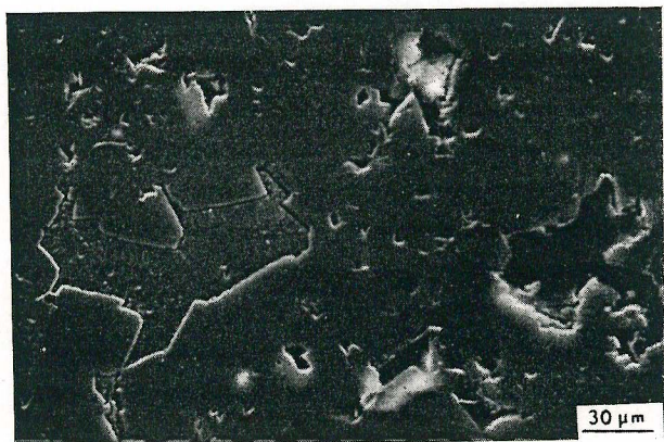
Figura 11.—Dolomía de Boñar, variedad B-2, muestra pulida. Aspecto de los grandes poros intercristalinos y de otros más pequeños intracristalinos, asociados a la dolomita (M. E. B. ×320).
