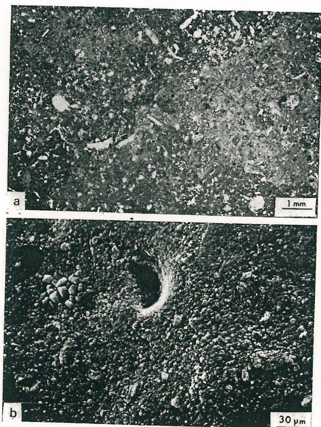
Figura 6.—Caliza de Laspra, variedad L-2. a) Micrita fosilífera removilizada, se observa algún grano de cuarzo y esparita (N. P.). b) Aspecto de los cristales de micrita, grabados por ácido (M. E. B., superficie atacada por CIH).
